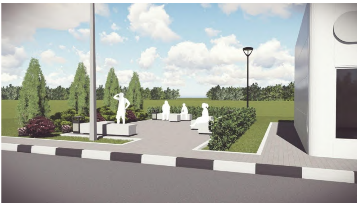
Освещение мест кратковременного отдыха Торшер высотой 2,5 - 3\text{м} .
