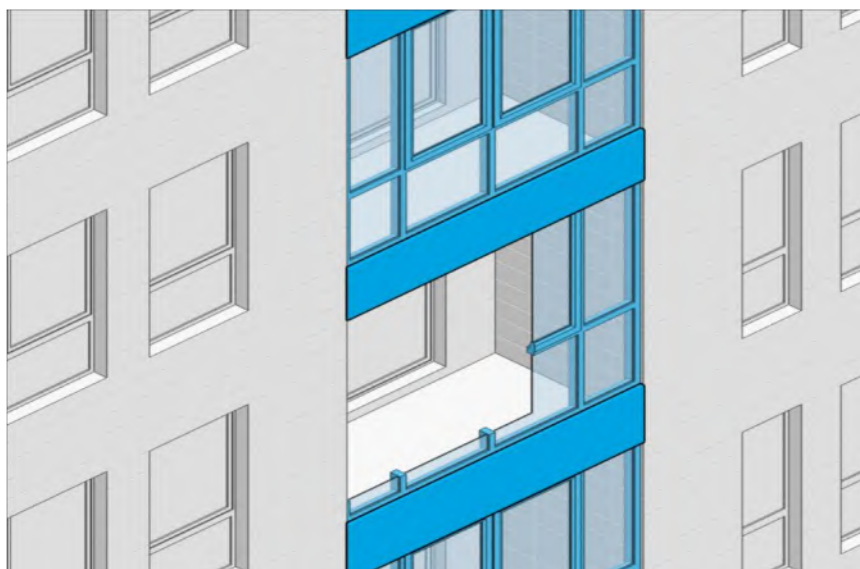
Глубина остеклённой лоджии минимум 1,5 метра.
