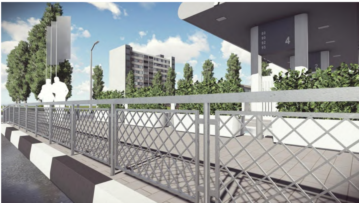
Ограждение пешеходной зоны от проезжей части
